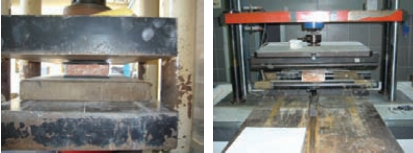
Fig. 29. Rotura a compresión y flexotracción de ladrillos macizos
