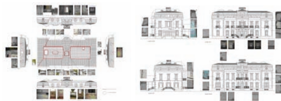
Fig. 10. Levantamiento de procesos patológicos de la cubierta y fachadas
