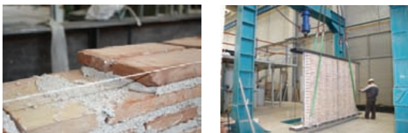
Fig. 1. Imagen del aparejo seguido en el proceso de construcción y proceso de colocación en prensa (Laboratorio de Resistencia al Fuego – AIDICO)
