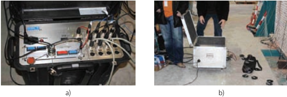
Fig. 6. Equipos para la monitorización estática (incluida auscultación sónica) (a) y tomografías sónicas (b).
