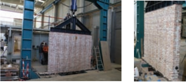
Fig. 3. Muro histórico colocado en la prensa, viga de reparto, célula de carga y prensa de compresión para estructuras verticales y horizontales.
