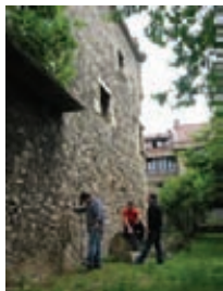
Fig. 7: Ensayo directo en el muro Sur con el emisor en el interior.
