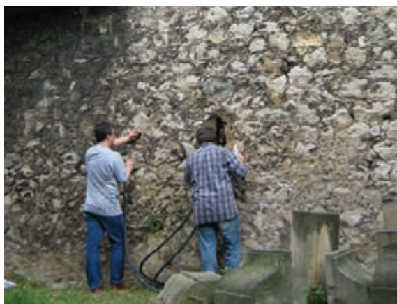
Fig. 1: Ilustración de uno de los muros del Palacio. Véase el operario a la izquierda sujetando el sensor apoyado en la superficie y el martillo en la mano derecha. A la derecha, otro operario sujeta el gel de acoplamiento y coordina el trabajo.
