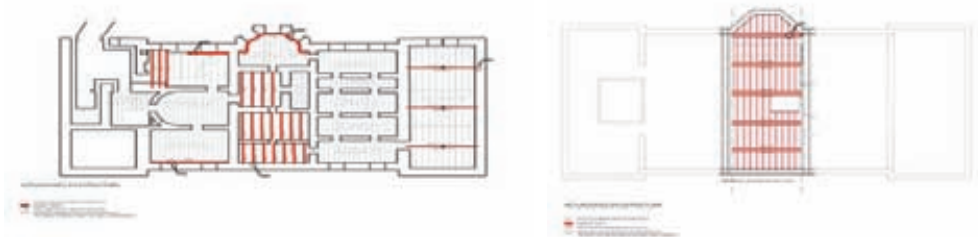
Fig. 17. Medidas correctoras de la planta baja y de la planta bajo cubierta
