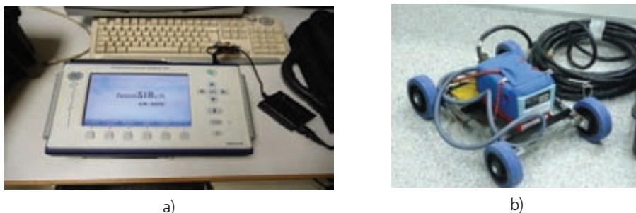
Fig. 9. Fotografía del GPR modelo 5100. a) Módulo de acondicionamiento, representación y almacenamiento de la señal (SIR 3000). b) Antena de 1.6GHz junto con acondicionador de señal (5100) y dispositivo de desplazamiento
