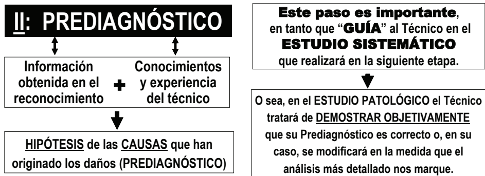
Fig. 13: Fase de prediagnóstico de una construcción con problemas.
