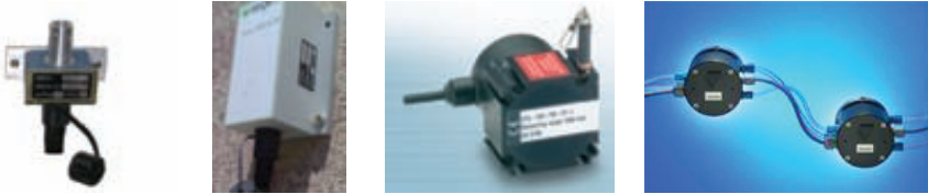
Fig. 3. Sonda de temperatura NTC/A, clinómetro, extensómetro y célula de asiento
