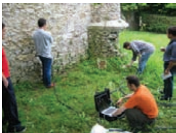
Fig. 5: Ensayo para medir el "ruido" en el exterior del muro de carga Norte.
