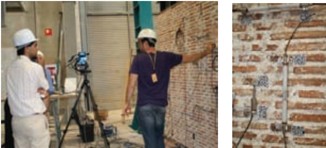
Fig. 11. Ensayo y equipo de videocorrelación en MURO2.
