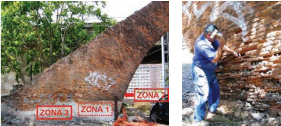
Fig. 3 y 4: Zonas de toma de muestras (la zona 1 corresponde con la cara opuesta a la mostrada en la fotografía) y detalle de un instante de las tareas de extracción.
