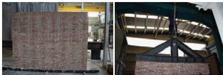
Fig. 4. Muro y sistema de reparto de carga
