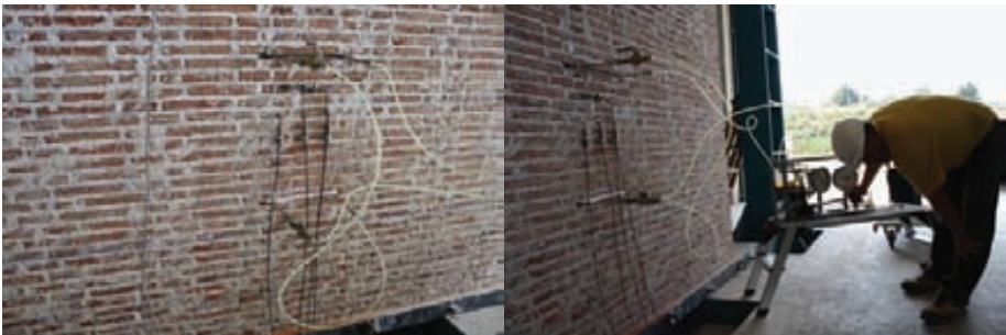
Fig. 8. Ensayo de Gatos Planos Dobles
