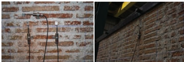
Fig. 6. Disposición de sensores LVDT en base del muro y en cabeza de muro
