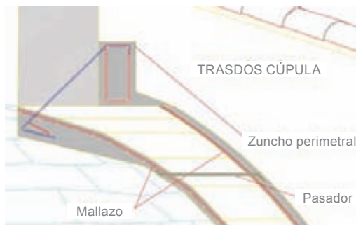
Fig. 42: Posible fenómeno de punzonamiento de la cúpula a nivel del entronque con la linterna.
