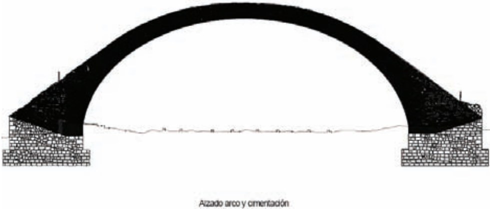
Fig. 26: Vista de cimentación y alzado
