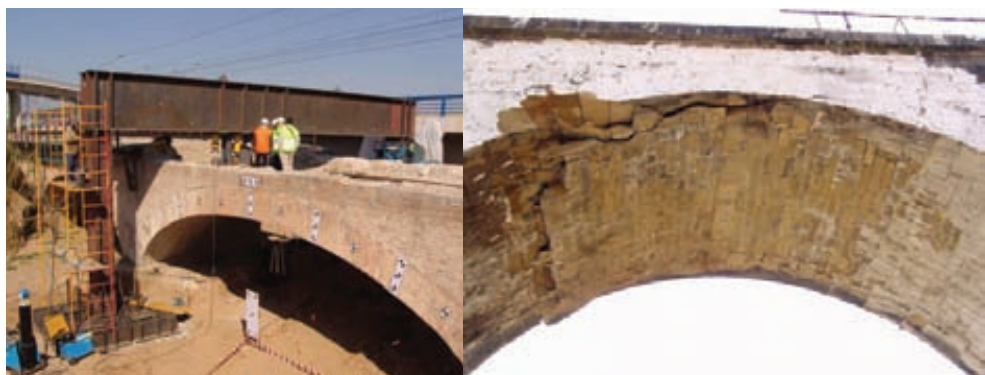
Fig. 18. Ensayos hasta rotura de los puentes de la Riera del Rubí (2005) y Urnieta (2007).
